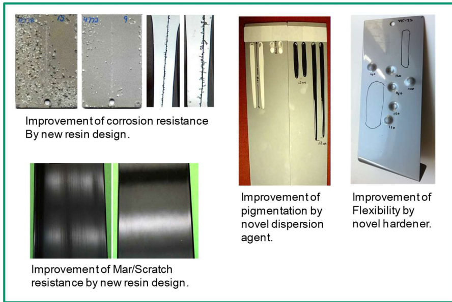
图 6 GMA 丙烯酸粉末涂料关键性能的改进
