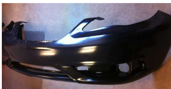
图 5 低温固化 GMA 丙烯酸粉末涂料在汽车保险杠上的应用
